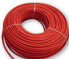
Conduttori flessibili in rame rosso, isolante in nastro di vetro/mica e miscela elastomerica. Guaina in miscela ritardante la fiamma in materiale termoplastico esente da alogeni a bassa emissione di fumi secondo CEI 20-11, EN 50363-0, qualità M1, VDE 0207 HM2. Colore guaina rosso. Temperatura di esercizio: -25°C...+90°C. Tensione di esercizio 100/100V. Tensione di prova 2000V. Disponibili su richiesta bobine da 500m.
